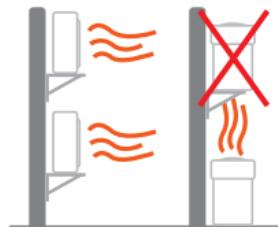
Condensadora com descarga de ar horizontal
